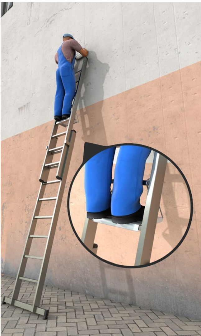
Abb. 17 Schiebeleiter mit Einhängepodest
